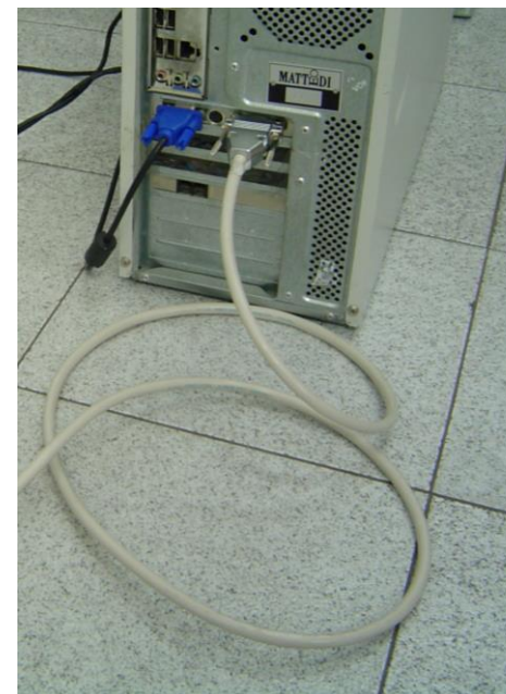
Foto 16: PC com Placa de vídeo 2 saídas e cabo adaptador DVI-VGA.
