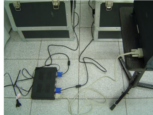
Foto 17: Conexão entre dois TediPrompters e um LapTop.
