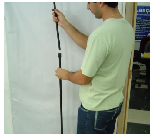
Foto 12: Montagem conjunto haste 4/5 no conjunto haste 1/2/3 e case.
