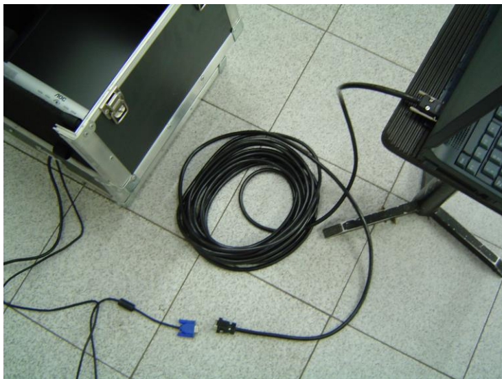
Foto 15: Conexão com LapTop e cabo VGA de 10 metros.
